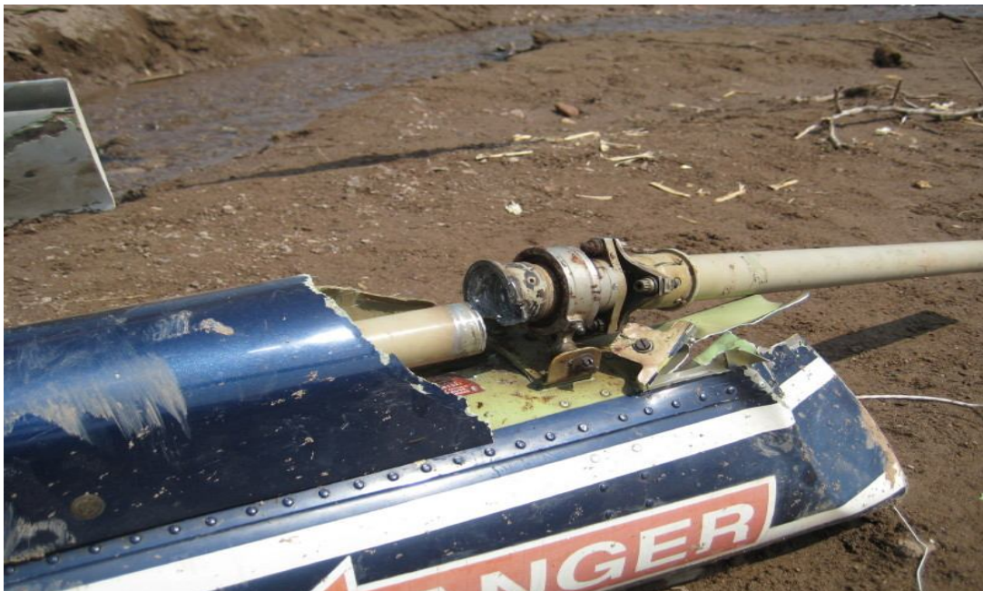
EJES PROPULSORES DAÑADOS POR EL IMPACTO
