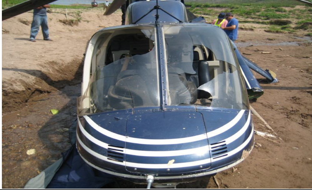
CABINA DE MANDOS SIN DAÑOS MAYORES
