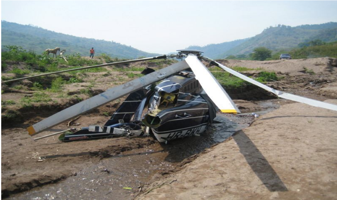
ROTOR PRINCIPAL CON PALAS GOLPEADAS POR EL IMPACTO
